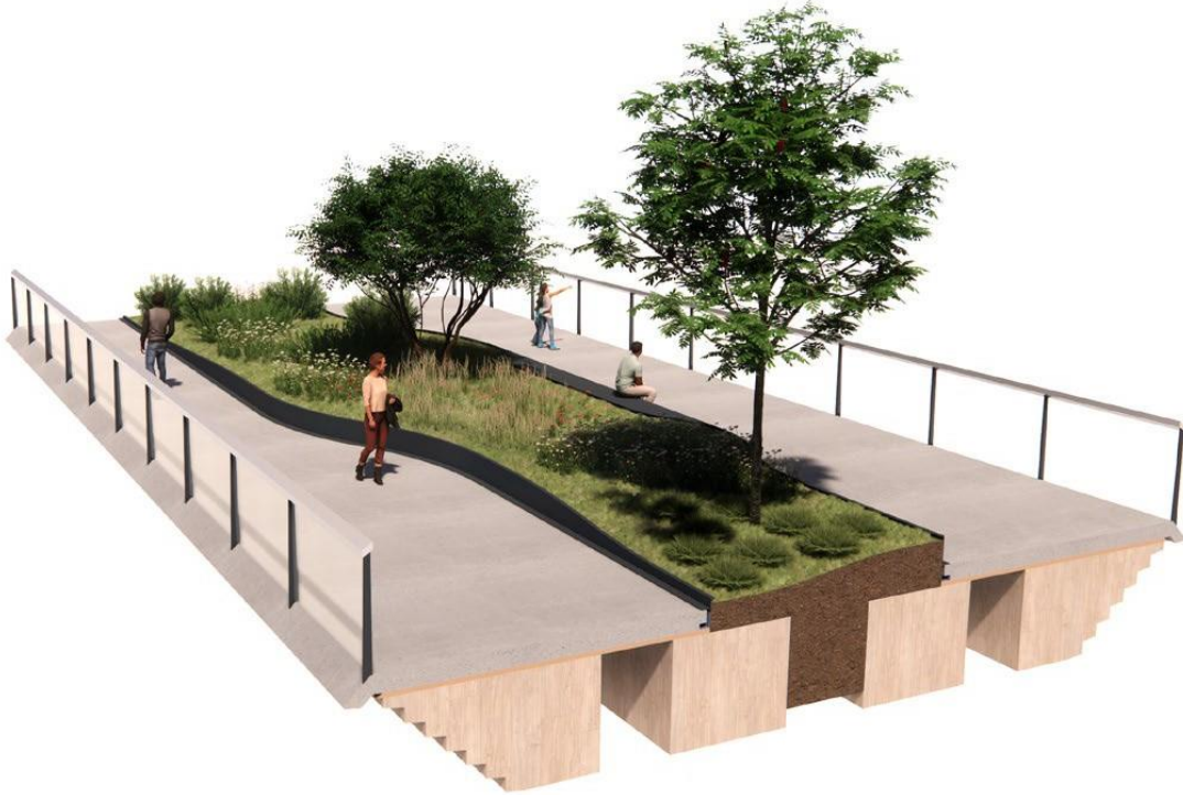
betonnen dek groenvakken tussen de liggers positioneren
