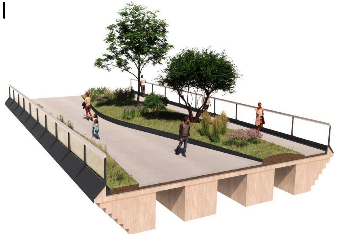
houten (CLT) dek groenvakken op het dek plaatsen
